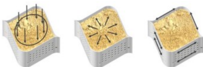
Joonis 13: Geokärje tööpõhimõte 3
