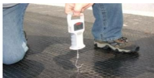
Joonis 25: Geosünteedi ja aluspinna vahelise nakke kontroll. 6
